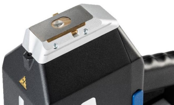
Рисунок 11 – Внешний вид защитного окна и порядок его установки на измерительную поверхность Анализатора
