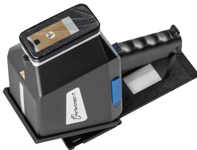
Рисунок 12 – Внешний вид зажимного приспособления и порядок его установки с защитной пленкой на измерительную поверхность Анализатора
